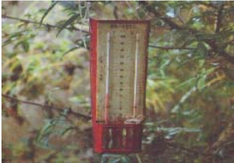
图 28 模拟园内悬挂的干湿温度计
